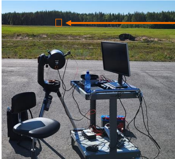
Testilaitteisto 450m kohdemittauksissa.
