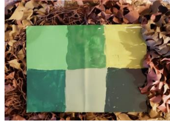
Testikohteita. Kaupallinen naamioverkko ja Metallilevy, jossa kaupallisia vihreitä maaleja.
