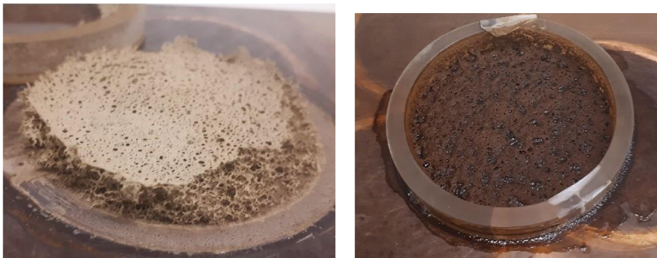
Kuva 4. 160 g/L ligniiniä sisältäneet selluvaahdot 90 minuutin jälkeen 54 °C lämpölevyllä. SDS vaahto kuivui kovapintaiseksi rakenteeksi (vasen) kun Tween-vahto romahti (oikea).
