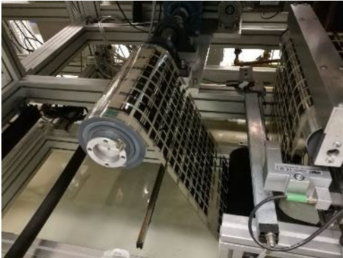
Kuva 5. Hiilipastan painaminen rullalta rullalle menetelmällä. Kuvassa valmiin rainan kelaus rullaksi prosessin lopussa.
