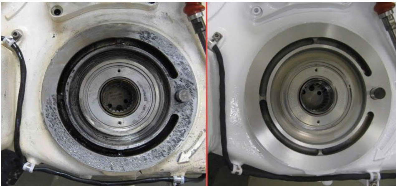
[2] Esimerkkinä F/A-18 superhornetin AMADin vaihdelaatikon korjaus kylmäruiskuttamalla (vasemmalla tilanne ennen korjausta ja oikealla korjauksen jälkeen). NAVAIR FRCSW North Island Cold Spray Implementation Team, https://www.secnav.navy.mil/innovation/Pages/2016/05/FRCSWColdSpray.aspx
