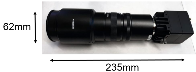
Kuva 4. Vastaanottimena käytetty kuvantava InGaAs anturi ja yksi työssä käytetyistä objektiiveista.
