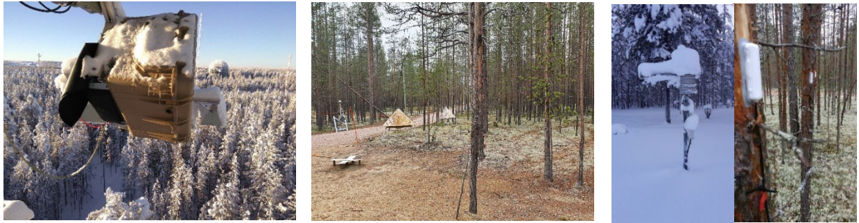
Kuva 3. Tutkimuksessa käytettyä Sodankylän Arktisen avaruuskeskuksen mittausinfrastruktuuria. SodSAR asennettuna mittaustorniin latvuston yläpuolelle (vas.); maastoon asennettuja kulmaheijastimia (kesk.); automaattinen sääasema ja puuston lämpötilan ja permittiivisyyden mittaus (oik.).
