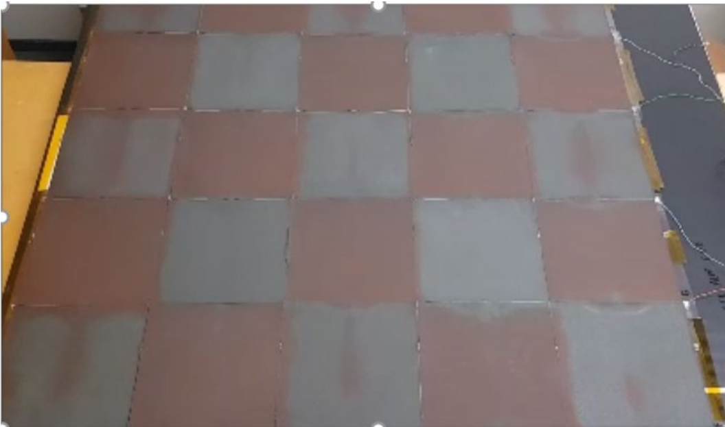
Kuva 6. Valmis integroitu demonstraattori, jolle kuvassa on ladattu shakkiruudukkokuva. Oikealla näkyy virransyöttöjohtimet sekä tukilevyn harmaata reunaa.
