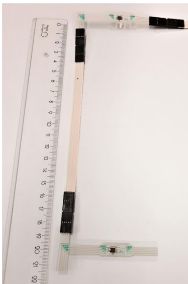
Kuva 10. Anturiliitännät ja koottu lämpötilan mittausmatriisi.
