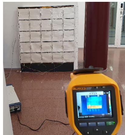
Kuva 12. Lämmitinmatriisin ohjain piirilevy ja lämmitinmatriisin testausta. Lämpökamerakuvassa näkyy läm-
