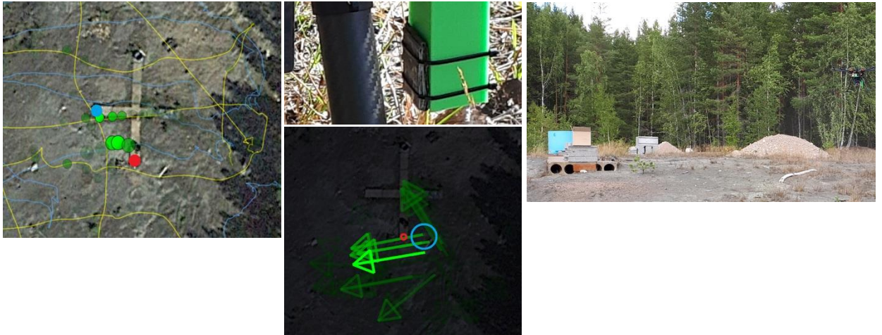
Kuva 3. Vasemmalla yhdistettynä tulokset lennoista 1 ja 2. Lennolla 1 Am-241- ja Ba-133-lähteet olivat sinisen täplän osoittamassa kohdassa. Lennolla 2 Am-241 oli edelleen sinisessä kohdassa mutta Ba-133 oli tällä kertaa punaisessa. Kromek GR1 tekemät havainnot Ba-133:sta on merkitty vihreillä täplillä. Keskellä olevissa kuvissa, lennolla 3 Kromekin kopterin takapuoleiseen kylkeen asennettiin 5 mm lyijyeste n. 1 cm etäisyydelle anturista, jolloin havaittu säteily vaimeni, kun kopterin keula osoitti pois päin lähteestä. Ba-133-lähde sijaitsi punaisen ympyrän kohdalla ja kopteri kääntyi ympäri sinisen ympyrän rajaamalla alueella. Oikealla kuva kasikopterista lentämässä testialueella. (Ortokuvien lähde: Google Earth, Landsat / Copernicus, 2015–2016)
