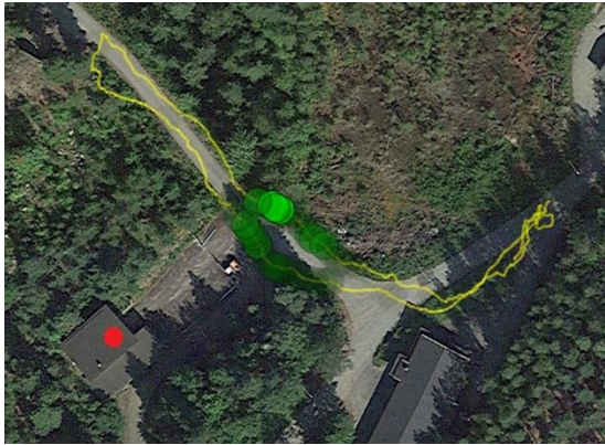
Kuva 5. Vasemmalla Cs-137-lähteen sijainti (punainen) suhteessa kasikopterin kontrollerin ilmoittamaan lentoreittiin ja mittauksiin. Oikealla Kromek GR1:n mittaamat datapisteet Cs-137-lähteelle (energia-alue 644,8–680,9 keV, jolla Cs-137:n gammasäteilyhuippu, 661,64 keV, sijaitsee) suhteessa CPC-mittauksiin (hiukkaspitoisuus eli havaittujen hiukkasten lukumäärä / kuutiokeskimetri ilmaa). Huomioitavaa on, että aerosolipitoisuutta ei tiedetä lentoalueen ulkopuolella.
