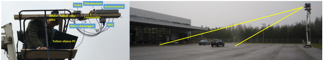
Kuva 1. Forssassa DA Design Oy:llä suoritettujen kenttäkokeiden mittausjärjestely ja kuvattu alue. Vasemmassa kuvassa esitetään tutkan ja oheislaitteiden asennus lavettina toimineeseen henkilönostimeen. Oikeassa kuvassa on kuvausalue ja tutkan lavetti näkyvissä. Henkilönostinta liikutettiin teollisuushallin seinän suuntaisesti, joka mahdollisti SAR-kuvan muodostamisen hallin ja nostimen välisestä alueesta. Tutkan elevaatio suunnan keilan valaisema alue on hahmoteltu kuvaan keltaisilla viivoilla.
