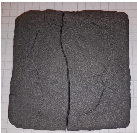
Kuva 9: Reaktiivisella kuumapuristuksella valmistettu Al_2O_3-B_4C -koelevy, mitat 100 mm x 100mm x 10 mm.
