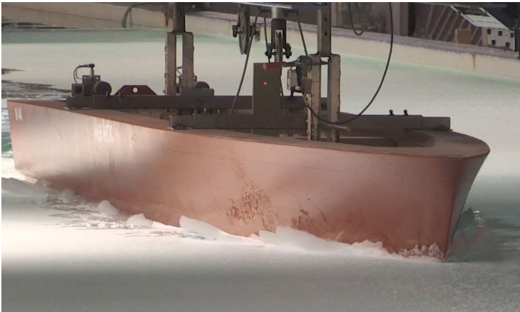
Mallikokeilla varmistetaan aluksen runkomuodon soveltuvuus jääolosuhteisiin.
