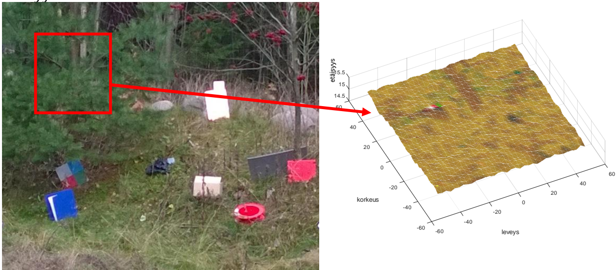
Kuva 5. 3D skannaus. Kenttämittauksissa mitatut kohteet (vasen) sekä skannattu ja näkyvälle aallonpituusalueelle visualisoitu 3D-pinta.
