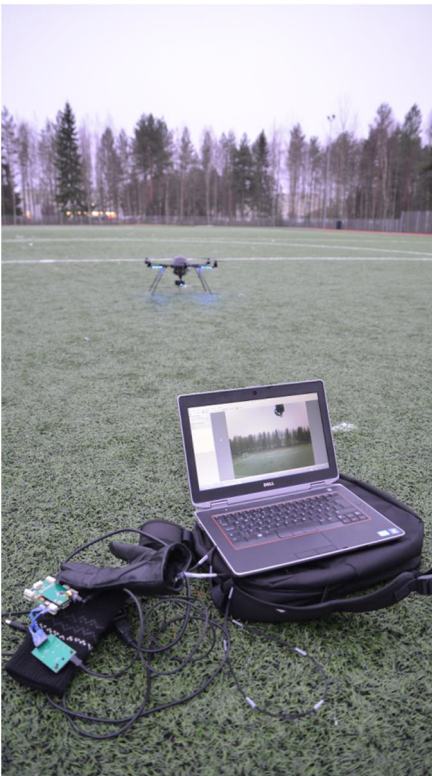
Kuva 6: Demonstroitu järjestelmä: Taustalla mikrokooperi sensorialustalla ja kameralla, edessä älykäsine sensorialustalla, sekä kannettava tietokone mihin kuvat tulevat. Älykäsineen sensorialusta vedettiin johdon avulla kauemmas käsiin kuvasta varten.
