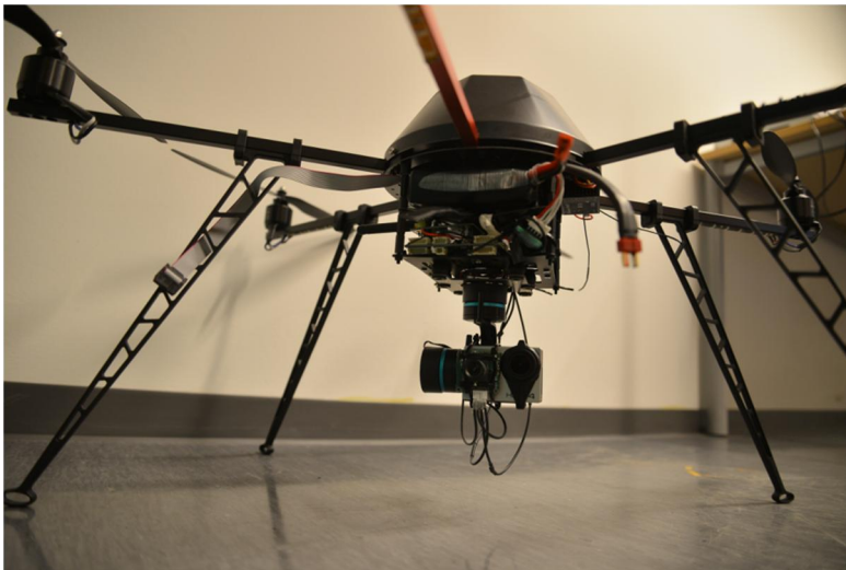
Kuva 2: MikroKopteri HexaKopter XL -pienoiskopteri. Kuvassa näkyvät myös sensorialusta sekä kamerat, joista alempi ottaa videokuvaa.
