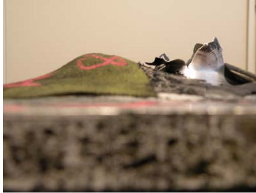
Kuva 2. Ampumakokeessa testattu Exote- materiaalin (kuvan alaosassa kuvakentän ulkopuolella) ja alumiinivaahtoytimisen kerroslevyrakenteen yhdistelmä. Sekä ensimmäinen läpäissyt että toinen pysähtynyt osuma nähtävissä.
