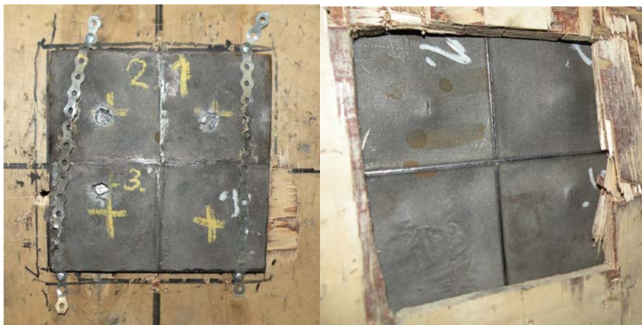
Kuva 8. Neljästä pienemmästä yhdistelmäateriaalilevystä backing- levyt hitsaamalla koottuun testilevyyn teräsytimisellä panssari- luodilla ammutut kolme koelaukausta sekä Exote- materiaalin (kuvan vasen puoli) että backing- levyn puolelta kuvattuna
