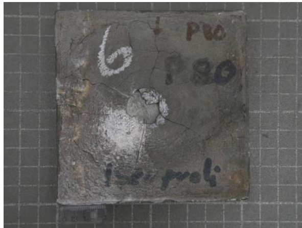
Kuva 6. Ampumakokeessa yhdistelmämaterialiin pysähtynyt teräsytiminen panssariluoti.
