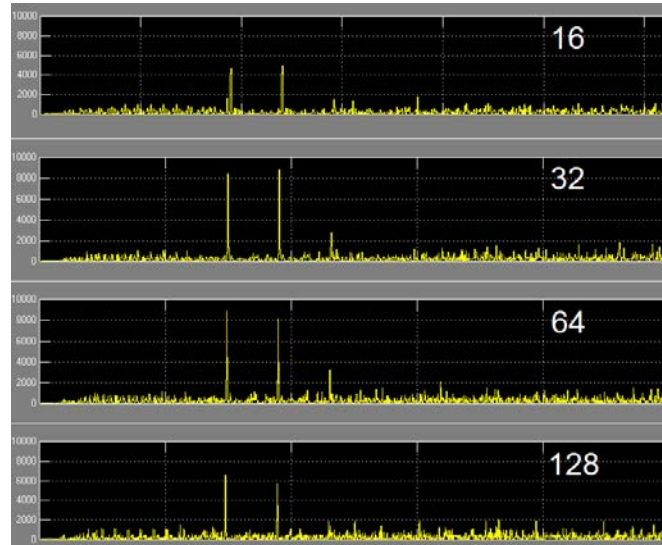
Kuva 2: System Generator simulaatioissa nähtävät korrelaatiopiikit eri desimointikertoimilla.
