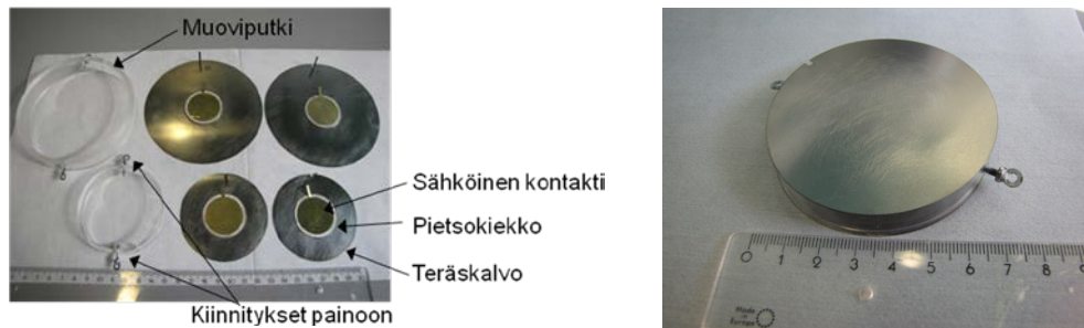
Kuva 3 a) Aaltorumpu prototyypin osat b) valmis \text{\O}70 mm prototyyppi.
